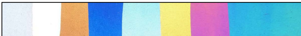
Рисунок 1. Многослойная полимерная пленка поливинилхлорида в проходящем поляризованном свете (количество слоев возрастает слева направо от 1 до 8)
