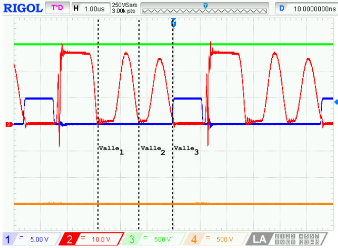
Figura 5: Formas de onda de voltaje del convertidor: C_1 (Azul)= V_{GS} , C_2 (Rojo)= V_{DS} , C_3 (Verde)= V_{O,P} , C_4 (Naranja)= V_{O,N}
