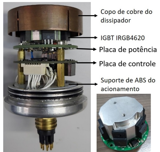
Figura 9. Montagem completa do acionamento.
