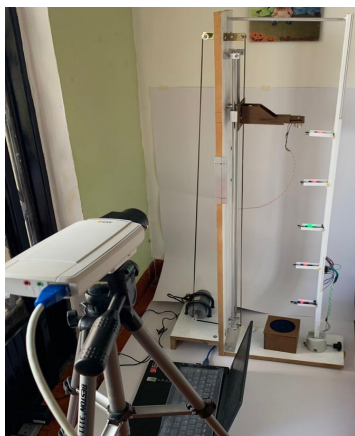
Fig 14. Monitoreo del montaje experimental de la planta de caída libre.
