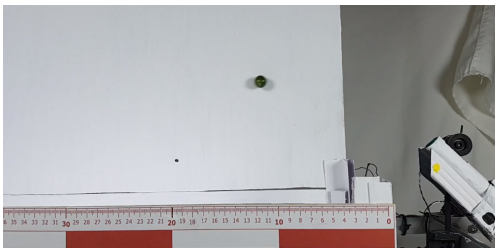
Fig. 7 Montaje experimental para la planta de movimiento parabólico
